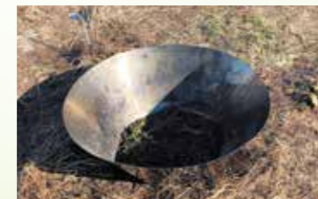
写真② 無煙炭化器(モキ製作所M100)
