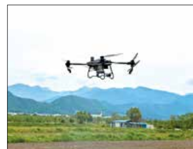
ドローンによる除草剤散布(約1haで移動含め4時間)
