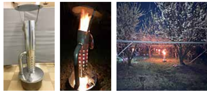
オイルヒーター 点火中のオイルヒーター 設置した園地の様子
